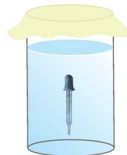
При нажатии на пленку стеклянный пузырек уходит на дно. Когда пленку отпускаешь, водолаз поднимается. Понаблюдав за поведением водолаза, нетрудно сообразить, в чем здесь дело. При надавливании на пленку воздух внутри бутылки сжимается, в том числе — и в самом пузырьке. Видно, как в пузырек заходит вода, он становится тяжелее и начинает опускаться.
